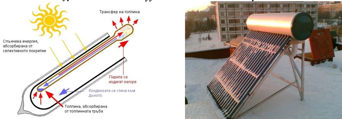
Фигура 10.Схема на вакуумен/топлинен колектор
