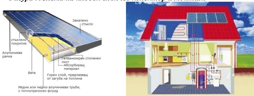
Фигура 9.Схема на плосък слънчев колектор и монтаж
